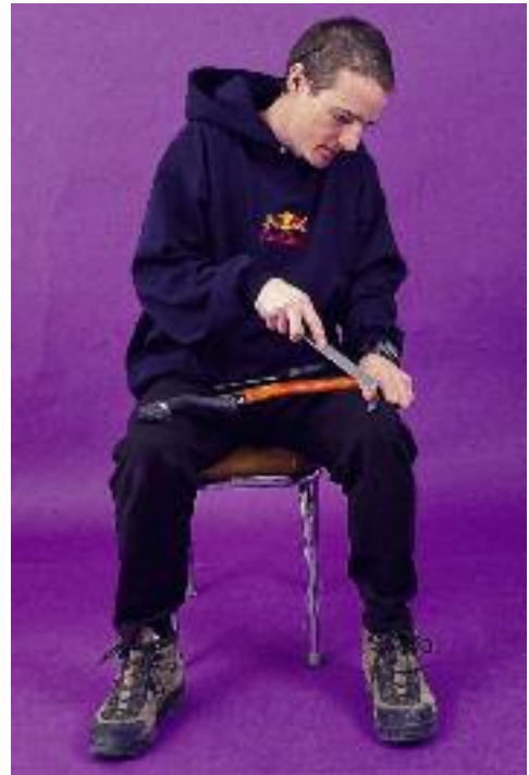
Para obtener mejores resultados, sujeta así el piolet cuando afiles la hoja.
