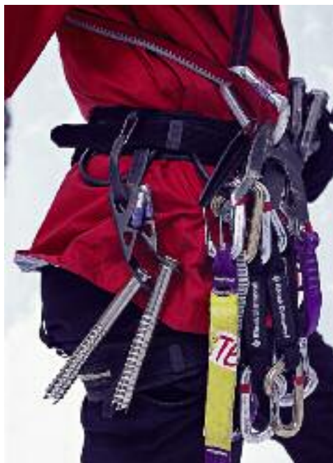
Un arnés equipado con Ice Clippers para llevar tornillos.
